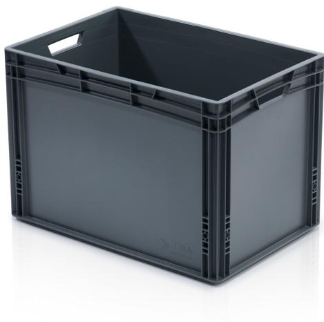
Die ECO Euro Kiste TBA ist ein vielseitiger Helfer in allen Industriebereichen. Die Kiste ist aus regranuliertem Material hergestellt und trägt somit zum Schutz unseres Planeten bei. Sie ist hygienisch, leicht stapelbar und kann für Transport und Lagerung verwendet werden. Optimiert für den Einsatz in der automatisierten Logistik (geeignet für den Einsatz auf Förderbändern und Rollenbahnen). Möglichkeit der Bedruckung.
