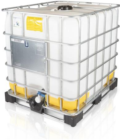
Elektrostatisch gesicherter Kunststoff-IBC-Container, geeignet für den Transport gefährlicher Stoffe nach ADR und gleichzeitig zur Lagerung von brennbaren Stoffen mit einem Flammpunkt unter 55 C° in Zone 1 und 2. Die verstärkte massive Stahlkonstruktion sorgt für die Ableitung elektrostatischer Aufladung .
